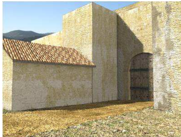
Figura 8. Detalle de la segunda fase con el adosamiento al interior de las torres.
