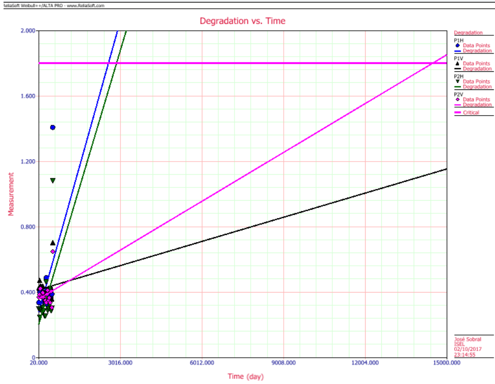
Figura 39 - Curvas de tendência de degradação dos pontos P1H, P1V, P2H e P2V do componente bomba (B 275 B)
