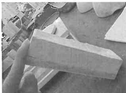
Figura 6. Calda de injeção com o plastificante Sika plast 912 (PLAST). Fonte: SANTOS, Jocileila L.; 2014.
