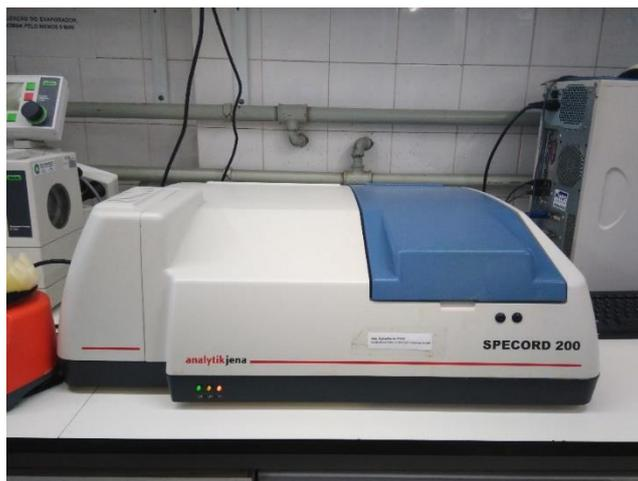
**Figura 7** - Espectrofotómetro AnalytikJena 200-2004 utilizado na leitura de absorvâncias
