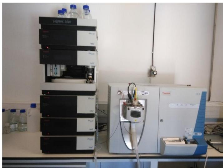
**Figura 8** – Equipamento HPLC acoplado a um detetor de DAD e ESI-MS
