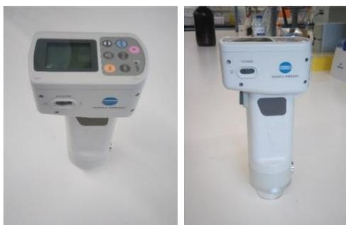
**Figura 15** - colorímetro (modelo CR-400, Konica Minolta Sensing Inc., Tóquio, Japão) utilizado para a determinação da cor dos croissants
