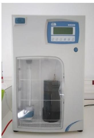
**Figura 14** - Equipamento Kjeldahl onde foram analisadas as proteínas
