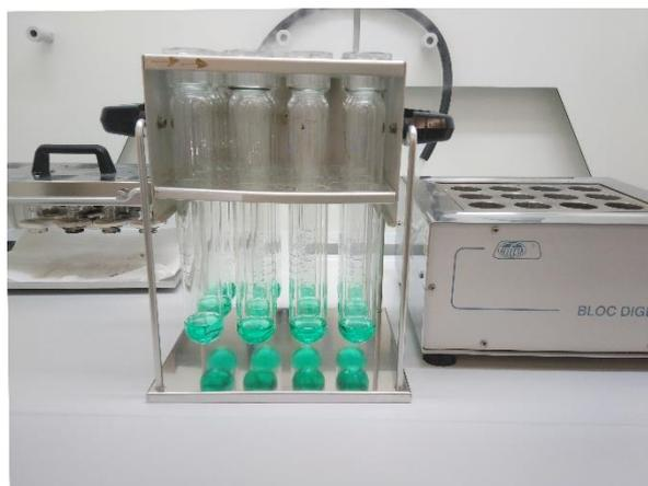
**Figura 13** - Digester (Foss<sup>TM</sup> Digester) e tubos de ensaio com amostra digerida
