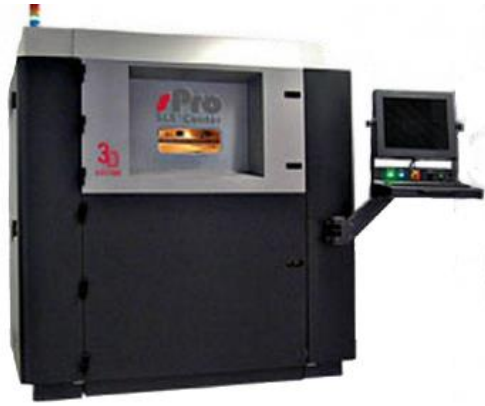
Figura 33-Máquina usando a tecnologia SLS [63].
