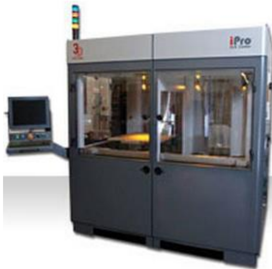
Figura 31-Máquina usando a tecnologia de SLA [58].
