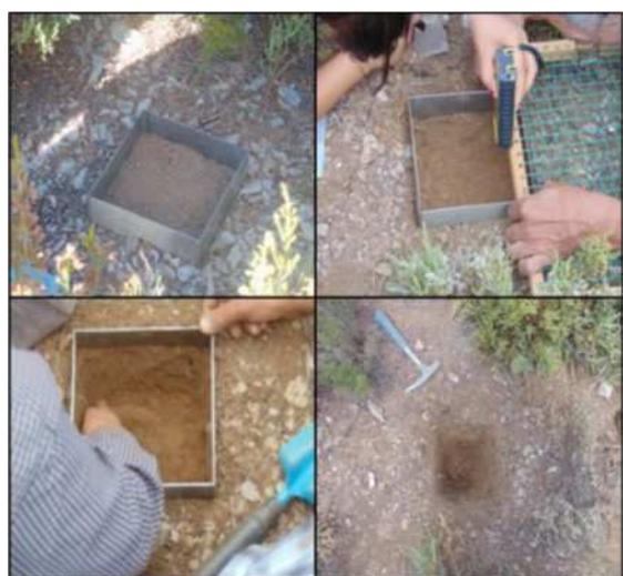
**Figura3** -Recolha de amostras de solo e medição da profundidade das camadas.
