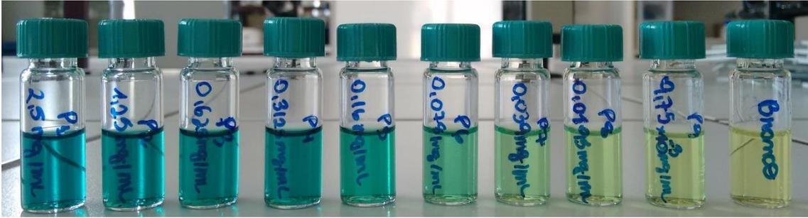
**Figura 8.** Fotografia da determinação do poder redutor da solução padrão de Trolox com concentrações decrescentes (da esquerda para a direita).
