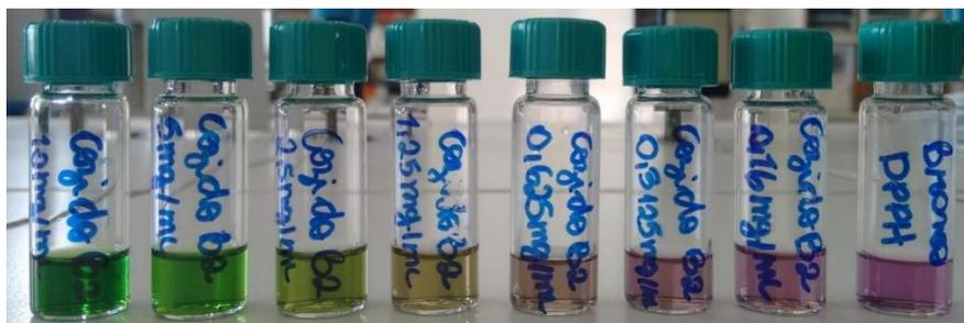
**Figura 16.** Fotografia da determinação da % de captação do radical DPPH utilizando extratos da amostra cozida B com concentrações decrescentes de extratos (da esquerda para a direita).
