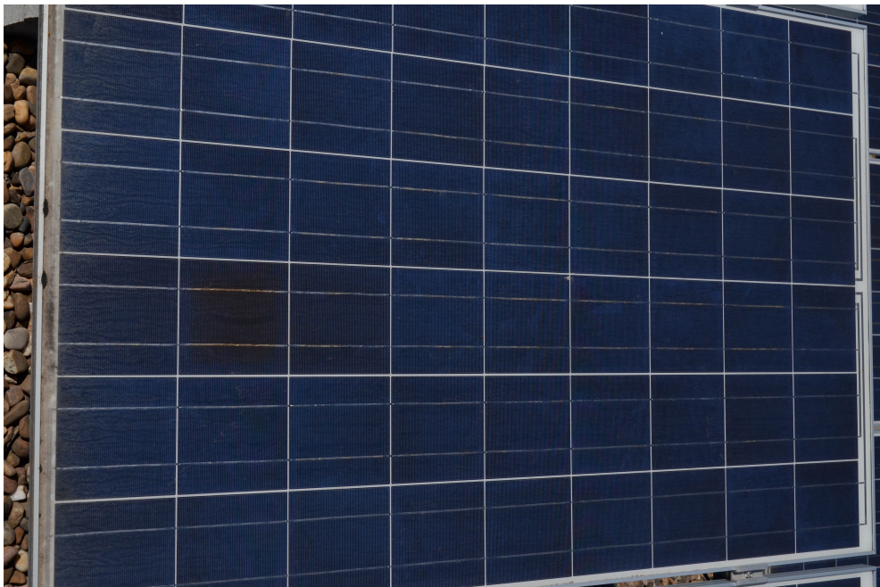
Figura 3.2: Módulo GEVPVp-205-M com sete anos de uso e célula danificada.
