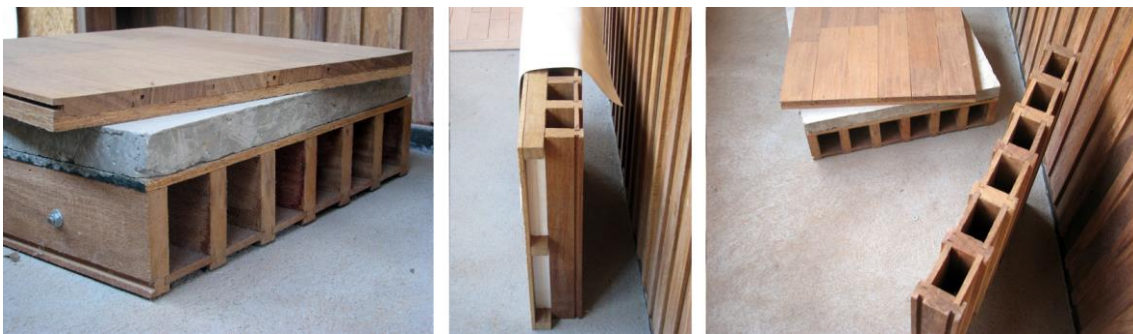
Figura 14: Lajes de madeira. [45]
