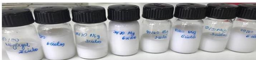
Figura 7. Emulsões preparadas com Miglyol utilizando razões O/A de 20/80, 30/70, 40/60 e 50/50 (da esquerda para a direita na imagem), utilizando 3 e 6 ciclos de passagem no homogeneizador de alta pressão, 3 semanas após a produção.
