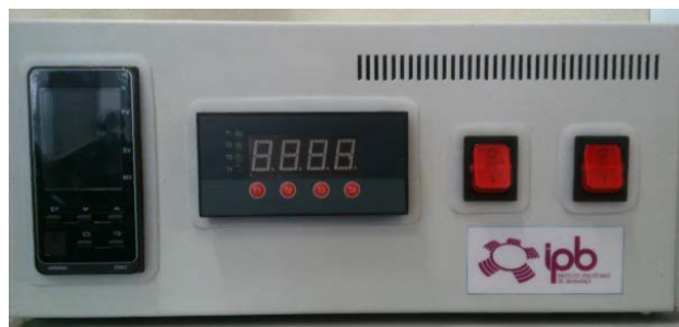
Figura 26- Unidade de controlo da temperatura no forno.
