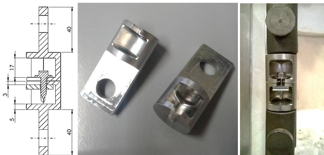
Figura 16- Instalação experimental para os ensaios de tração dos parafusos.
