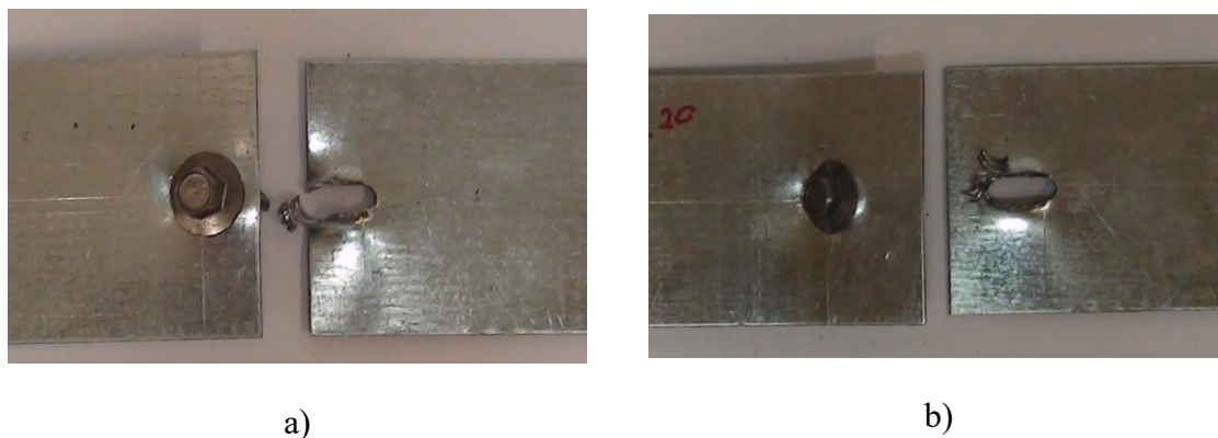
Figura 45- Apresentação do modo de rotura após ensaio à temperatura 20 [°C], a) provete 280_10_10_10_T20 (BFM), b) 280_10_10_20_T20 (BFM + TFM).
