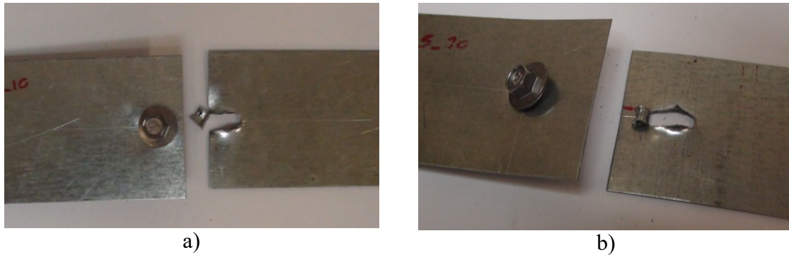
Figura 38- Apresentação do modo de rotura após ensaio à temperatura 20 [°C], a) provete 280_05_05_10_T20 (BFM), b) 280_05_05_20_T20 (BFM + TFM).
