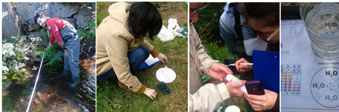
Figura 3 – Alguns aspetos da metodologia utilizada no Projeto Rios (a. Medição das margens; b. identificação e contagem dos macroinvertebrados; c. caracterização físico-química da água do rio; d. verificação do nível de transparência usando o disco de Sechi (Projeto Rios)
