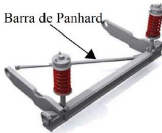
Figura 4 - Barras de ancoragem (Sleiman, 2010).
