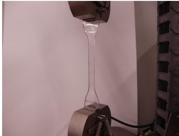
Figura 2.8 – Teste de tração. Figura conforme [42].
