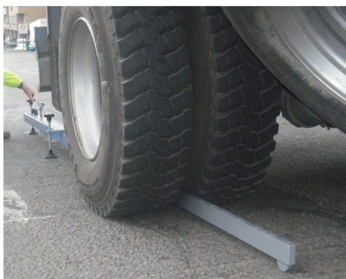
Figura 1. Avaliação “in situ” da deflexão
