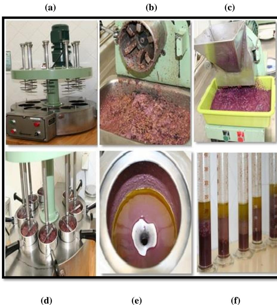
**Figura 3.** Representação esquemática das diferentes fases do processo de extração usando uma linha do tipo Abencor. a) Sistema de extração tipo Abencor b). Moinho para triturar polpa e caroço da azeitona c) Moenda da pasta da azeitona com adição de
