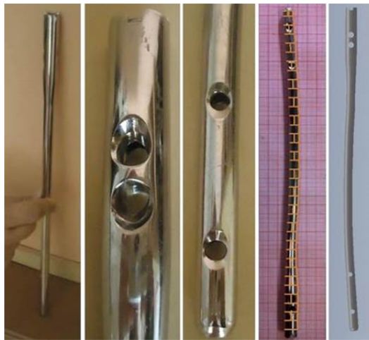
Fig. 3. Haste intramedular ( Hexagon ) e modelo CAD .
