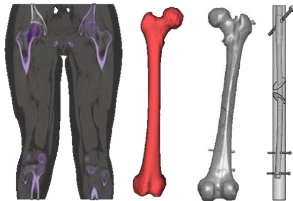
Fig. 2. Biomodelo do fêmur, Biomodelo e Modelo Simplificado (osso-haste-parafusos).
