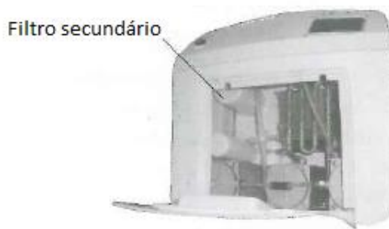
Figura 7-4 -Limpeza do filtro secundário do equipamento [11].
