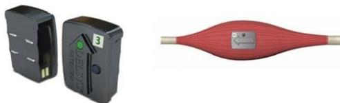
Figura 3.9: Sistema utilizado para eletromiografia, e representação da colocação do eletrodo no ventre muscular.
