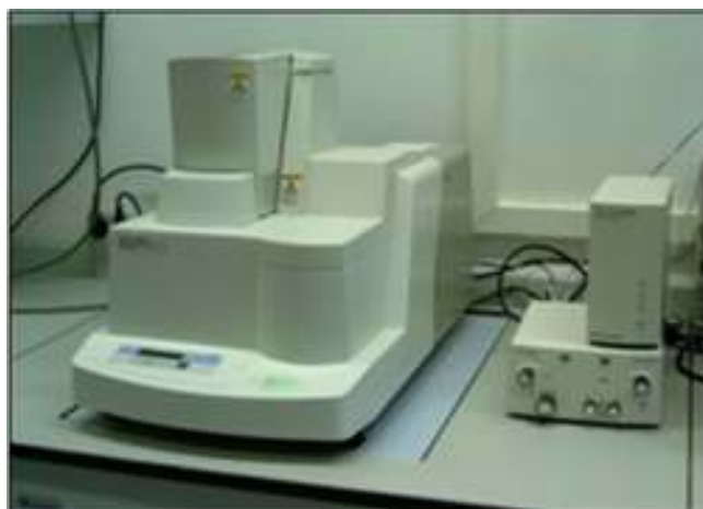
Figura 2.8 - Balança termo gravimétrica (Marca SHIMADZU Modelo DTG-60H)
