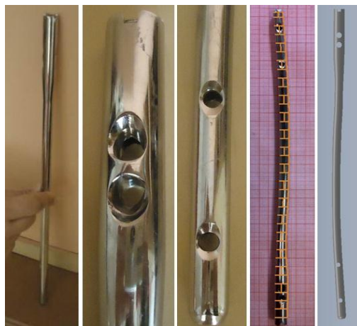
Figura 18: Haste intramedular ( Hexagon ) e modelo CAD .
