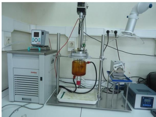
**Figura 3.2.** Reator utilizado na síntese das PUDs.
