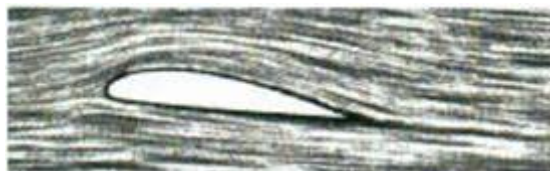
Figura 2.24: Fluxo aderente ao perfil [CRESESB-Centro de Referência para Energia Solar e Eólica, 2008].
