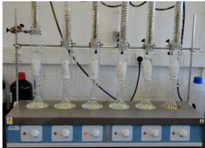
Figura 3. Extração da gordura das sementes em extrator Soxhlet.
