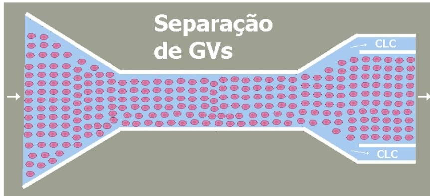
Figura 3 - Microdispositivo microfluídico capaz de extrair o fluido fisiológico com uma pureza semelhante à obtida com métodos convencionais de centrifugação (adaptado de [7]).
