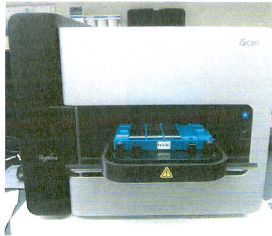
(b) iScanReader de Illumina se usa para analizar la señal de fluorescencia del BeadChip.
