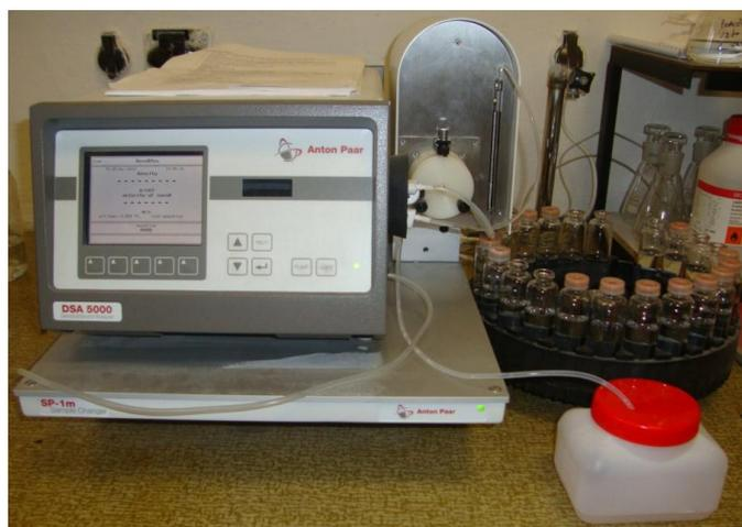
**Figura 7** - Medidor de densidades e velocidade do som Anton Paar DSA 5000.
