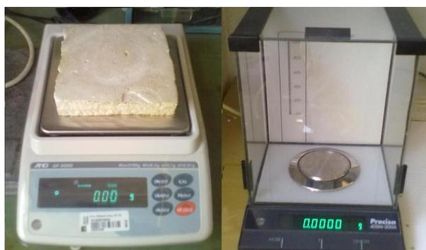
**Figura 9** - Balança analítica de 2 casas decimais (lado esquerdo) e balança analítica de 4 casas decimais (lado direito).
