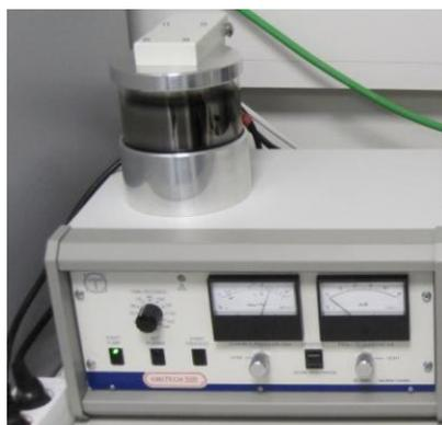
**Figura 29:** Equipamento de deposição catódica (*Sputter Coater*).
