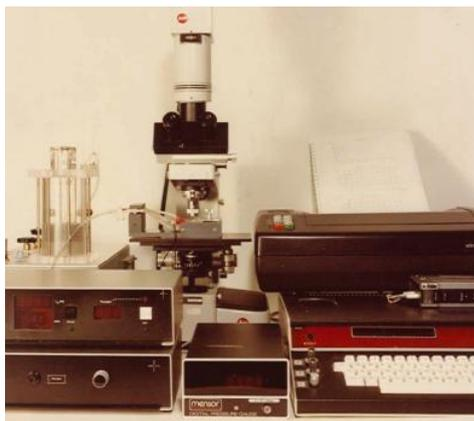
**Figura 12:** Equipamento “*Single Pore Rigidometer*” [Adaptado de Kieseweter et al. (1991)].
