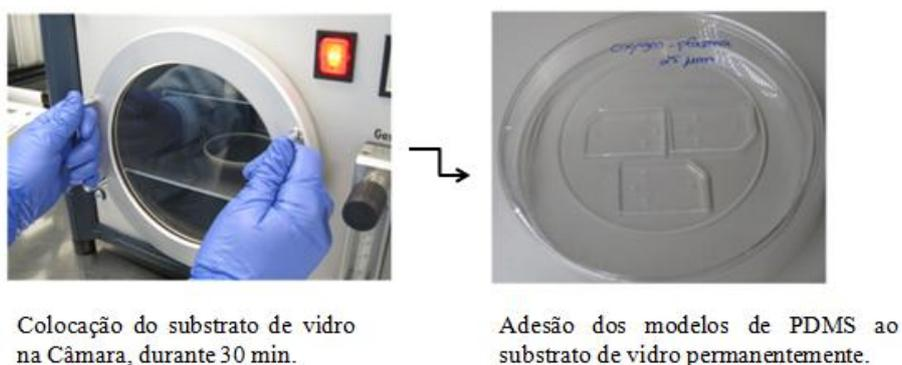
**Figura 37:** Moldes de PDMS fixados ao substrato de vidro.
