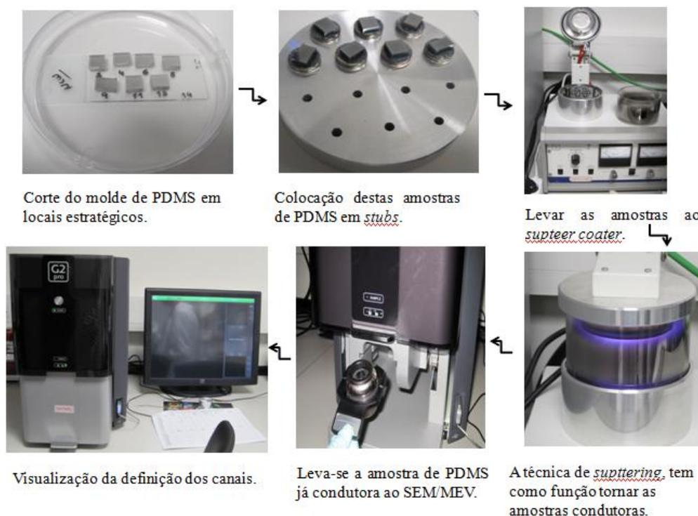
**Figura 35:** Processo de preparação da amostra.
