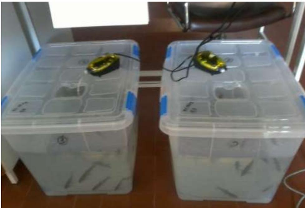
**Figura 3.3** - Exemplo dos tanques usados nos ensaios de exposição ao cobre.
