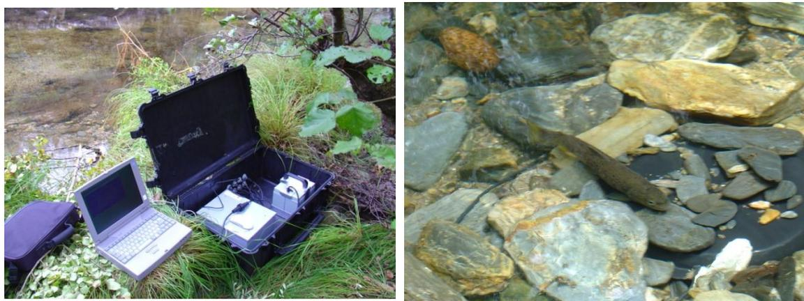
Figura 10. Equipamento de PIT-Telemetria: Instalação no troço do MPD e das antenas.
