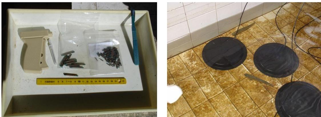
Figura 6. Equipamento de PIT-Telemetria (PIT-tags e antenas de detecção)
