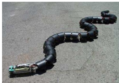
Figura 16. “ Snake robot ” do Politécnico de Nanyang em Singapura (43).
