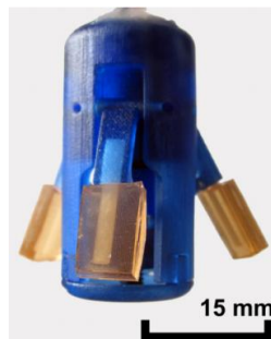
Figura 12. Cápsula endoscópica de Paul Glass et al (40).
