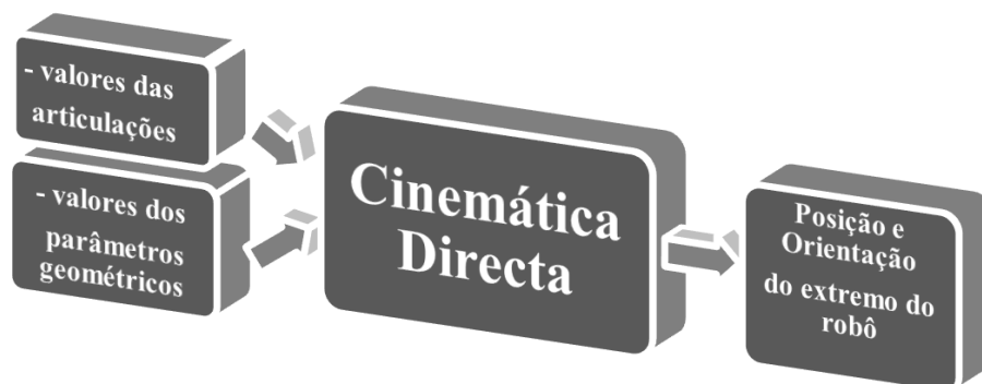
Figura 27. Diagrama da cinemática directa.
