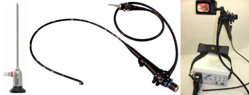
Figura 2. Endoscópio rígido (4) à esquerda, o fibroscópio GQR8-4-1500 (com ocular) (5) ao centro e o vídeo-endoscópio com monitor integrado (6) à direita.
