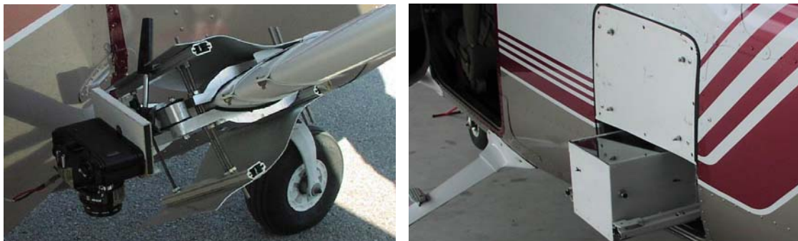
Figura 1. Plataformas utilizadas para obtenção de fotografias aéreas de pequeno formato. À esquerda, instalação externa no tirante do avião; à direita plataforma retráctil instalada no compartimento das bagagens, após remoção da respectiva porta.
