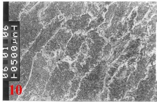
Figura 3-32 – Micro-estrutura da zona fundida, material de adição. (100x)
