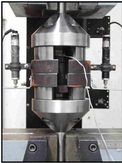
Figura 2-26 – Peça em aço para traccionar parafusos.
