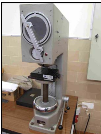
Figura 3-33 – Máquina do ensaio de dureza “Vickers”.
