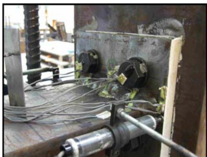
Figura 3-192 – Vista superior da placa de extremidade.
