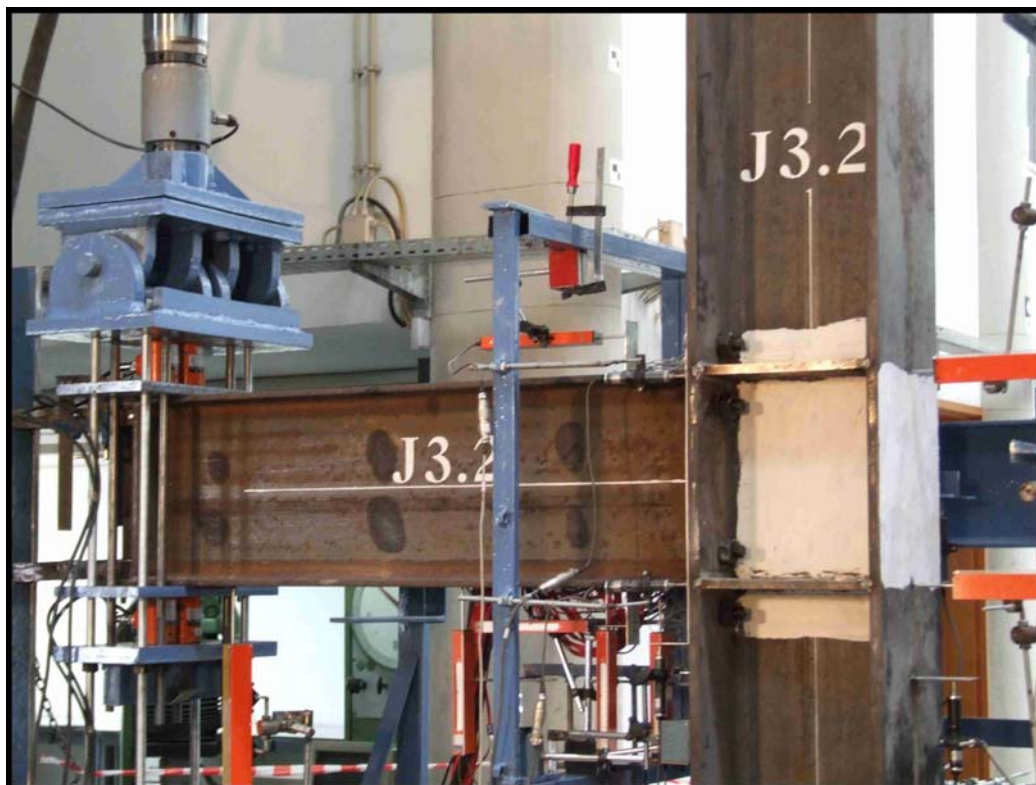
Figura 2-33 – Ilustração da localização de alguns deflectómetros e das células de carga.
