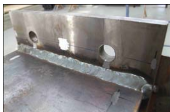
Figura 2-37 – Marcação da posição do extensómetro.
