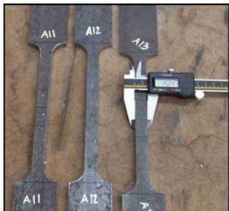
Figura 2-19 – Medição da secção e identificação individual.
