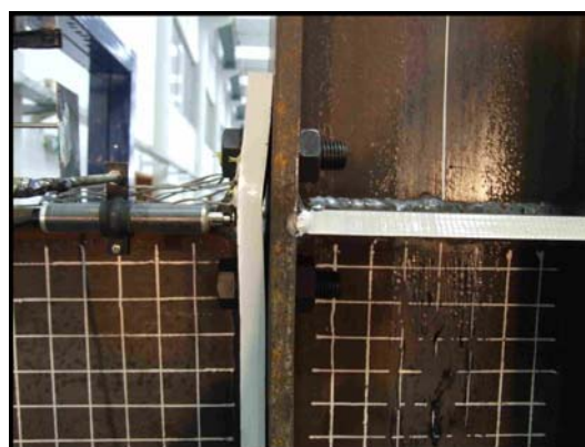
Figura 3-76 – Pormenores da deformação da placa de extremidade.
