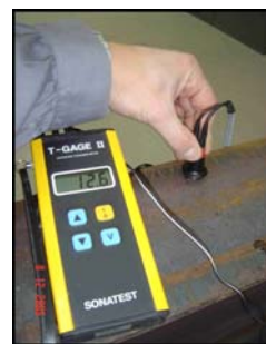
Figura 2-12 – Equipamento de ultra-sons (Sonatest) para medição de espessuras.
