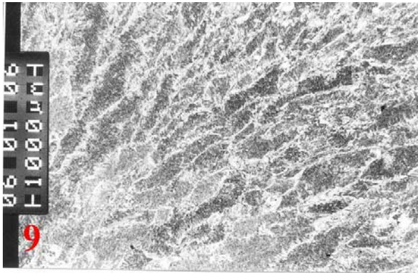
Figura 3-31 – Micro-estrutura da zona fundida, material de adição. (50x)
