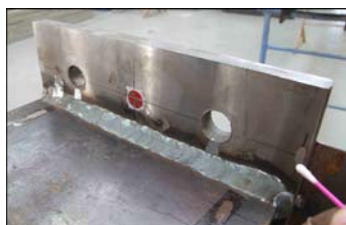
Figura 2-38 – Limpeza da área de colagem.
