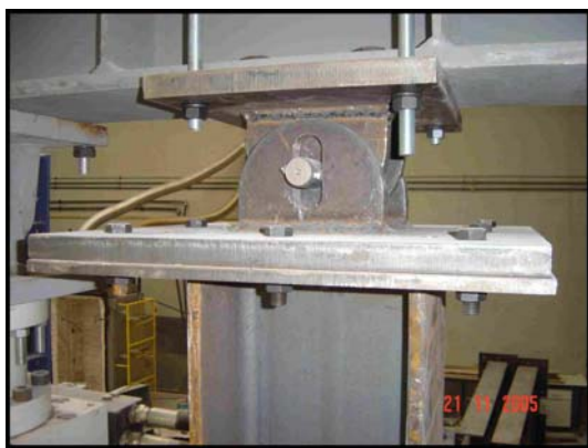
Figura 3-8 – Pormenor do apoio superior do pilar.
