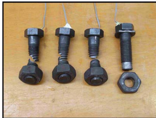
Figura 2-27 – Modos de rotura observados.
