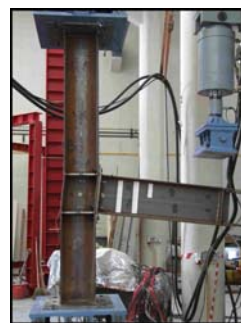
Figura 3-176 – Vista geral da ligação após ensaio.
