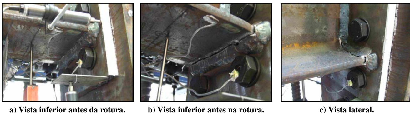
Figura 3-191 – Modo de rotura da ligação.
