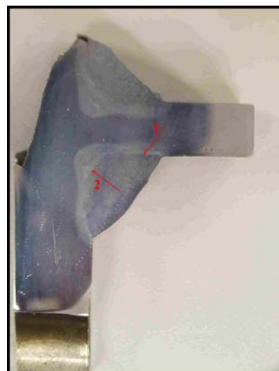
Figura 3-34 – Posição das direcções segundo as quais o ensaio de dureza foi realizado.
