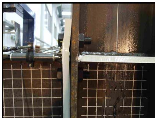
Figura 3-156 – Pormenores da deformação da placa de extremidade.
