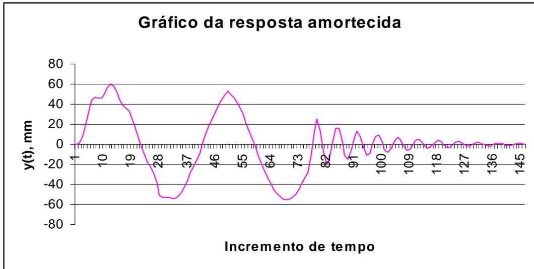
Figura 5.15 Resposta amortecida ao longo do tempo determinada analiticamente.
