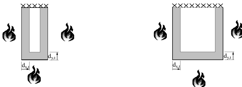
Figura 46: Carbonização da coluna rectangular e quadrangular com fogo em três direcções.
