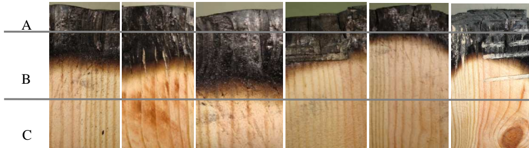
Figura 33: Zonas de degradação nas amostras ensaiadas no final de 3600 [s] (Barreira, et al., 2008).
