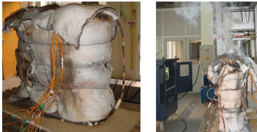
Figura 30: Isolamento e aquecimento das amostras.
