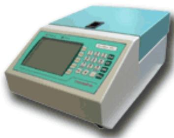
**Figura 3 – Aparelho utilizado para a medição de  $a_w$ , LabMASTER-aw da Novasina.<sup>[11]</sup>**
