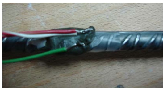
Figura 9. Protección de las galgas extensométricas
