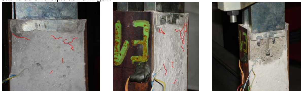
Figura 24. Proceso de rotura de la probeta.
