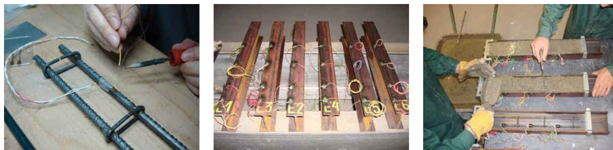
Figura 10. Proceso de elaboración de las probetas.
