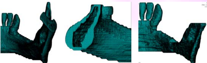
Fig. 2 – (esq.) Modelo discreto, com simetria, com osso cortical e trabecular, implantes e coroas de cerâmica; (centro) Modelo discreto, com simetria, para osso trabecular; (dir.) Modelo discreto, com simetria, do osso trabecular, com implantes e dentes artificiais. Nota: não foi possível modelar uma mandíbula completa por limitações de processamento informático.
