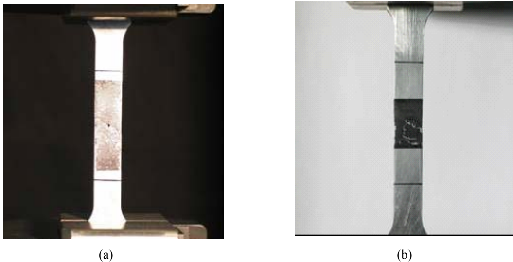
Figura 8. Fotografias de o ensaio de tracção num provete com rede de linhas paralelas (a) e de linhas cruzadas (b).
