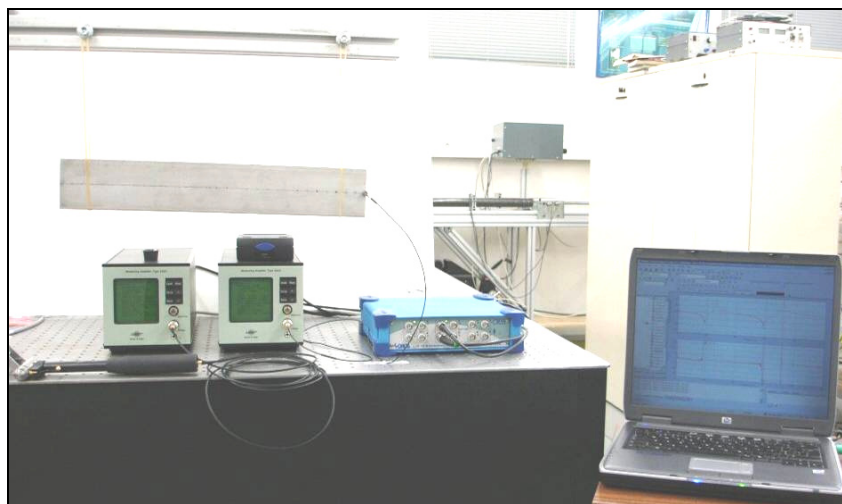
Fig. 5.9 – Imagem da montagem experimental para a medição das FRFs da viga livre-livre.
