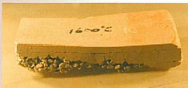
Fig. 8 — Deformação de um provete compósito de molochite/zircão após ensaio a 1600 C durante 10 minutos e arrefecimento em ar calmo Deformation of a molochite/zircon compound sample after testing at 1600 C for 10 minutes and cooling under room conditions
