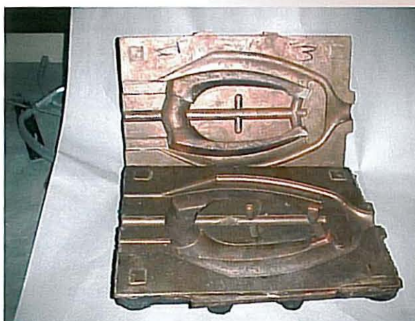
Fig. 10 – Coquilha metálica destinada ao fabrico de torneiras por fundição
