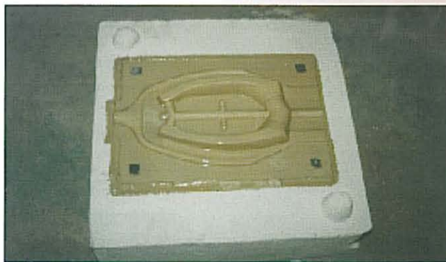
Fig. 2 — Moldação cerâmica compósita constituída por uma casca cerâmica (cor escura) que reproduz os detalhes do modelo e por um enchimento que dá a resistência à moldação compósita.
