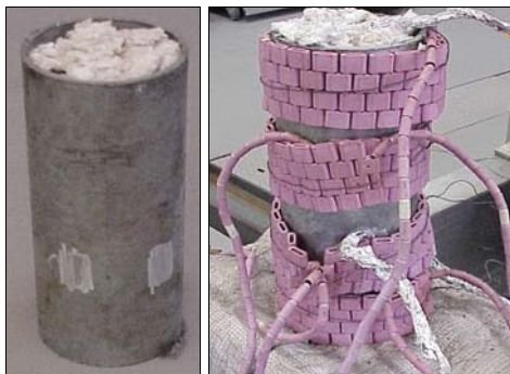
Fig. 17 – Preparação do ensaio: colocação de resistências eléctricas e isolamento no interior do tubo.
