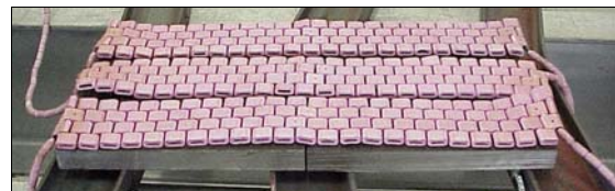
Fig. 3 – Preparação do ensaio: colocação de resistências eléctricas.
