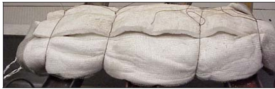
Fig. 4 – Preparação do ensaio: colocação da manta de isolamento.
