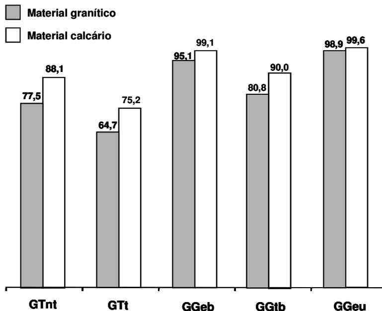
**Figura 10** – Resistência retida (em %) nos geossintéticos danificados em laboratório.
