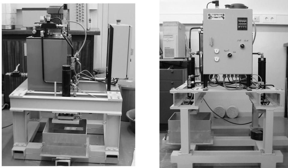
**Figura 3** – Vista geral do equipamento de danificação de geossintéticos.
