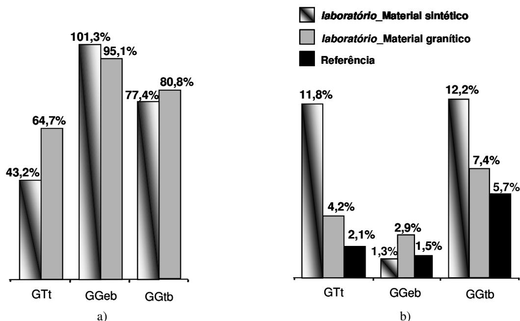
**Figura 14** – Danificação durante a instalação de geossintéticos: a) resistência retida; b) coeficiente de variação.
