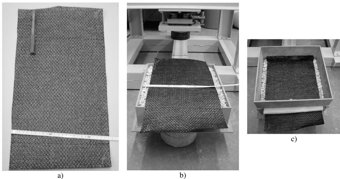
**Figura 5** – Provete de geossintético; a) dimensões; b) posição do provete na caixa inferior; c) colocação da caixa superior.
