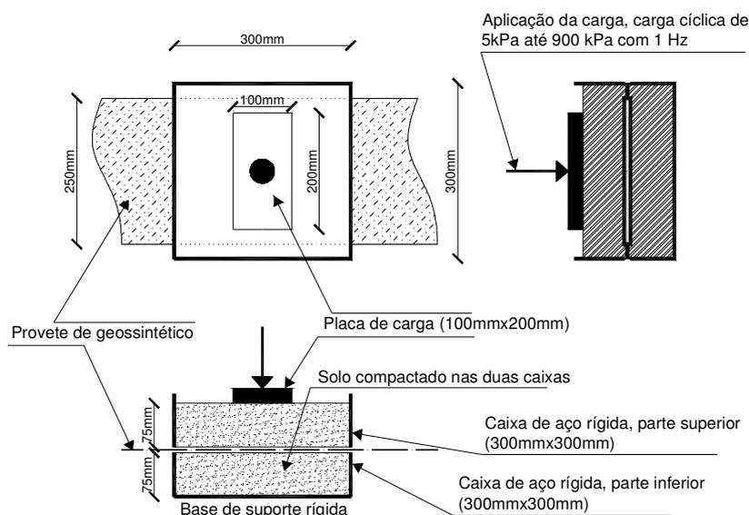
**Figura 1** – Representação esquemática da caixa de danificação.
