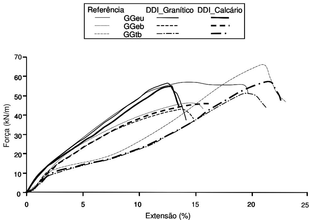
**Figura 12** – Curvas tracção-extensão das geogrelhas de referência e danificadas com os materiais granítico e calcário.
