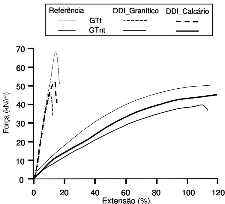
**Figura 13** – Curvas tracção-extensão dos geotêxteis de referência e danificados com os materiais granítico e calcário.
