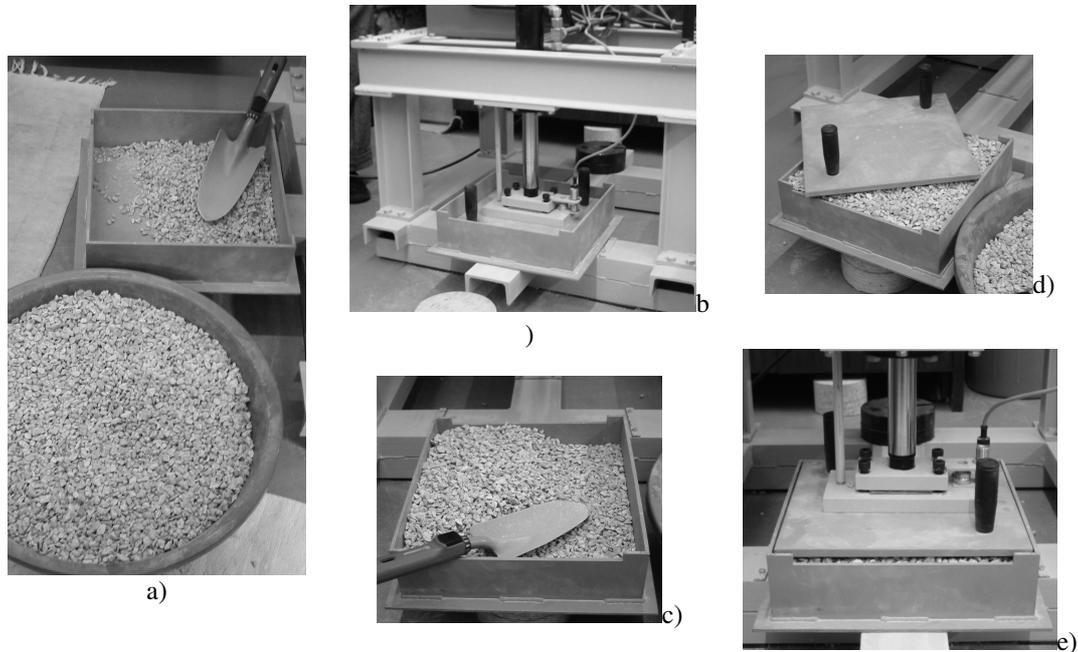
**Figura 4** – Enchimento da caixa inferior: a) colocação da 1ª camada; b) compactação da 1ª camada; c) colocação da 2ª camada; d) e e) compactação da segunda camada.
