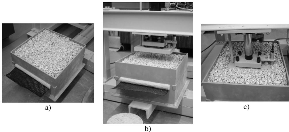
**Figura 6** – Caixa de danificação: a) enchimento da caixa superior; b) posição da caixa de danificação; c) aplicação da carga cíclica.
