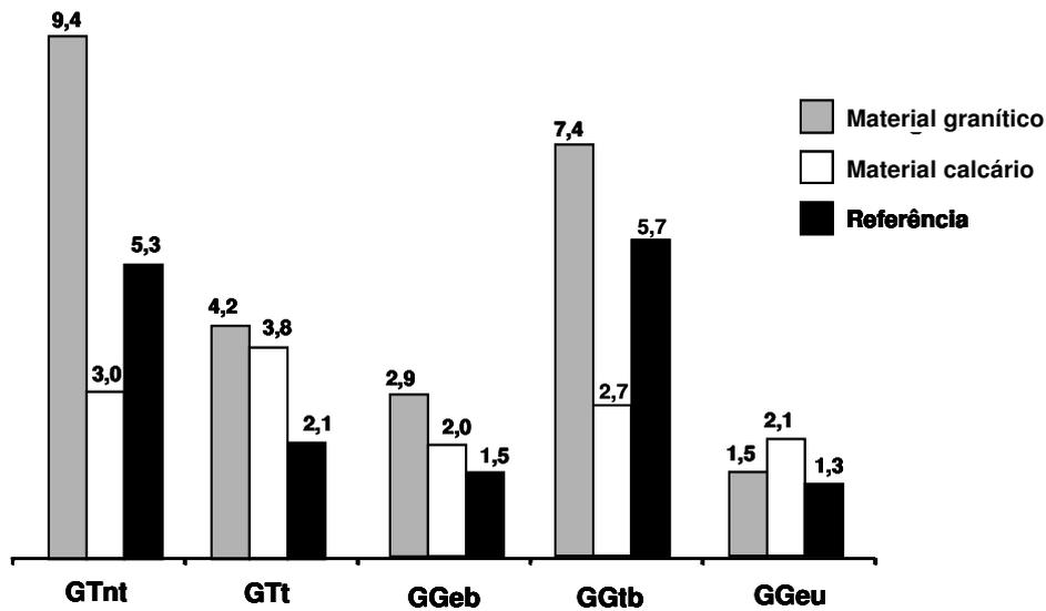
**Figura 11** – Coeficiente de variação (em %) da resistência à tracção dos geossintéticos.
