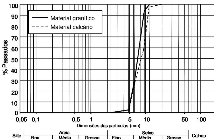
**Figura 9 – Curvas granulométricas dos materiais granulares de confinamento.**
