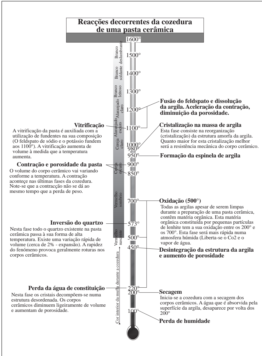
Figura 10 - Principais fases da acção do calor sobre um corpo cerâmico 3
