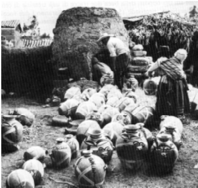
Figura 127 - Introdução das peças com engobe para cozer num forno no Peru 1 .
