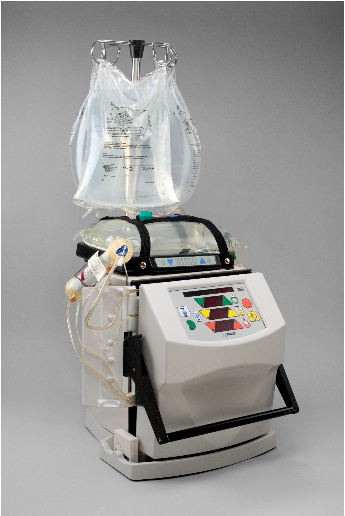
Figura 4: Cyclor System One montato e pronto per la seduta emodialitica
