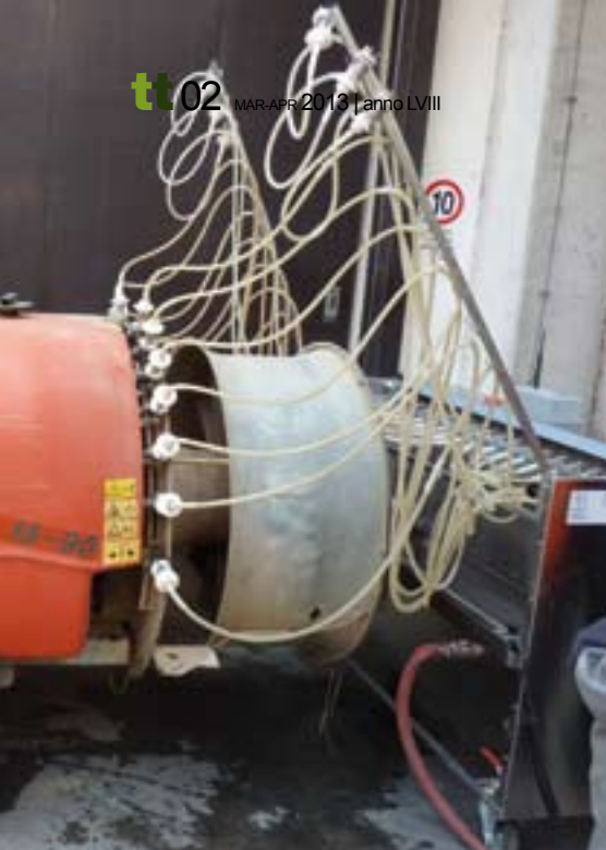
Misurazione della portata di ogni singolo ugello
