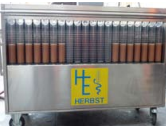
Misurazione della portata di ogni singolo ugello
