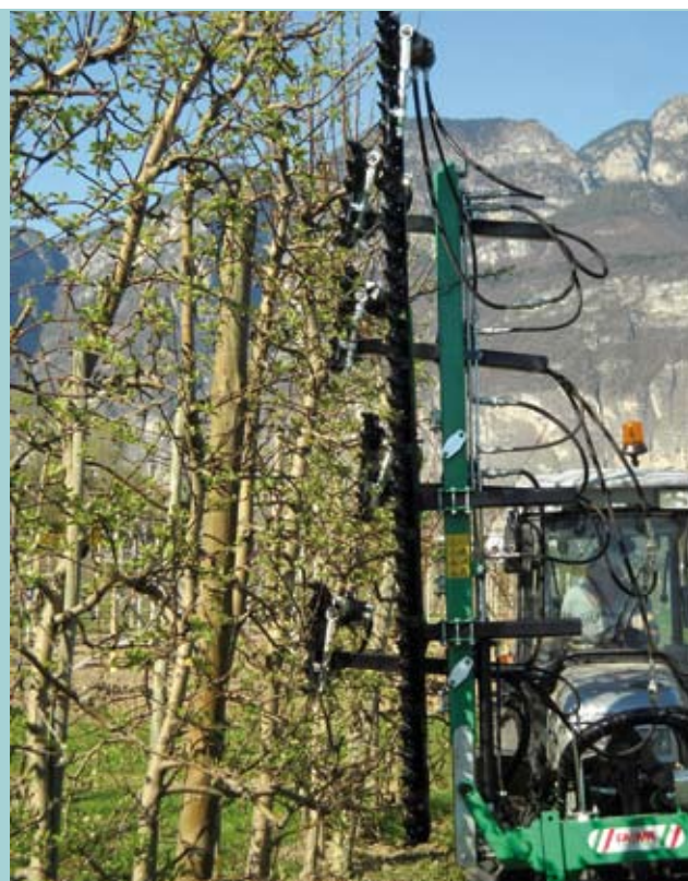
Prototipo di cimatrice a doppio piano di taglio per la potatura invernale del frutteto
