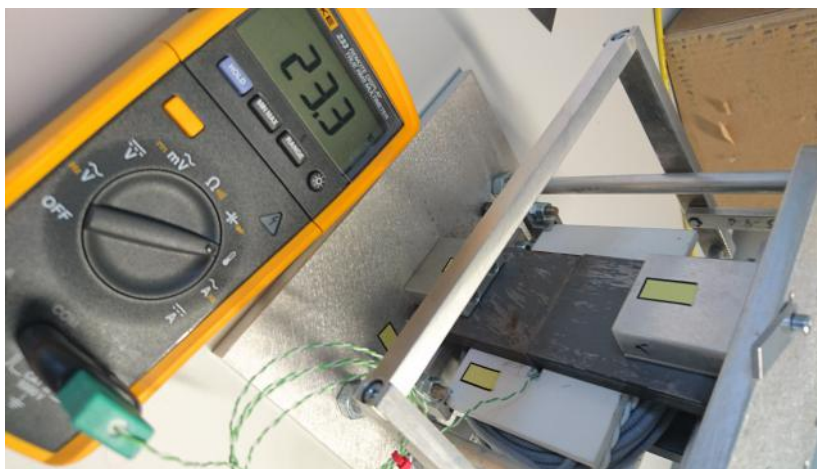
FIGURE II.35 – Photo du SST avec mesure de température via un thermocouple fixé sur la tôle
