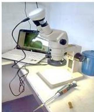
**Figura 5:** lupa de disección con cámara adosada al ocular.
