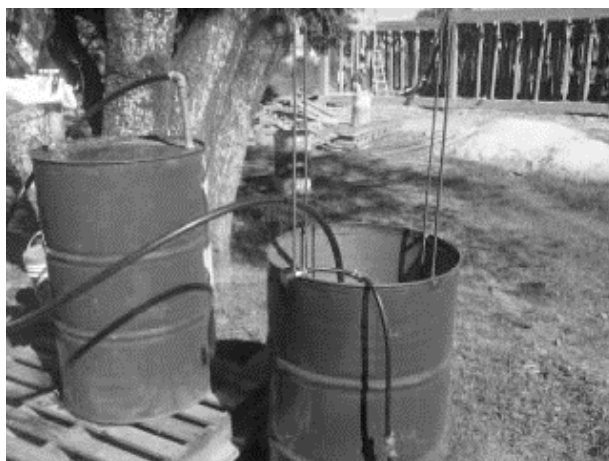
Figura 6. Biodigestor. Tacho de la izquierda contiene la biomasa y el de la derecha la campana para recoger el biogás.
